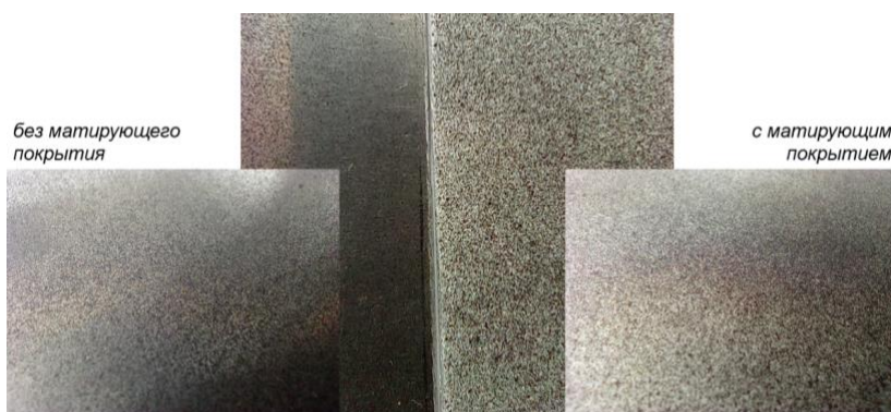
Рис. 9. Рисунки на поверхности образцов, полученные нанесением чёрной аэрозольной краски
