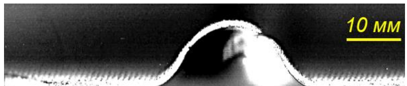
в) диаметральный разрез образца после испытаний
